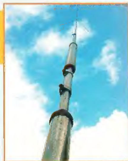
Traps en taploeding in de praktijk, een trap isoleert de rest van de antenne voor één band.
